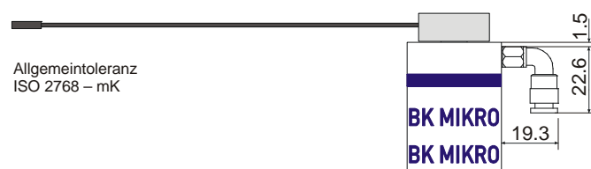
Abb. 4-7: Mechanische Abmessungen – Option Sperrluft Light Adapter
